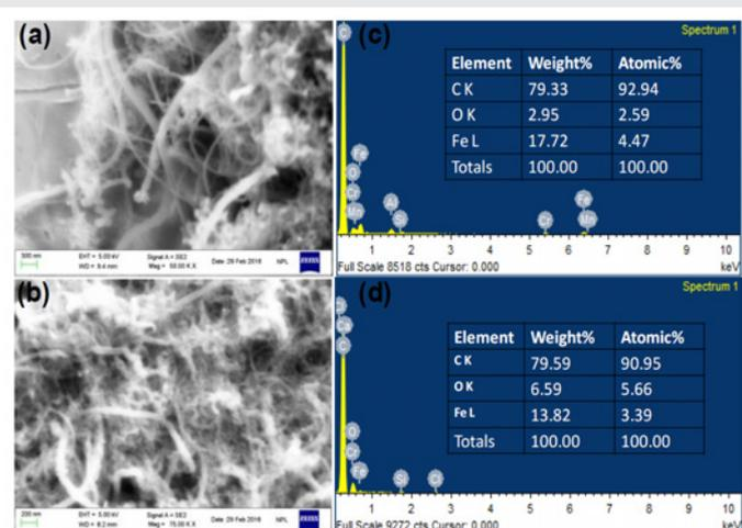
**Figure 3:** FESEM micrographs of (a) pristine CNTs & (b) FCNTs; and EDX spectra of (c) pristine CNTs & (d) FCNTs.
